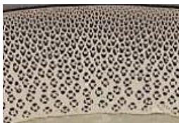
図-1(a) 竹の断面
