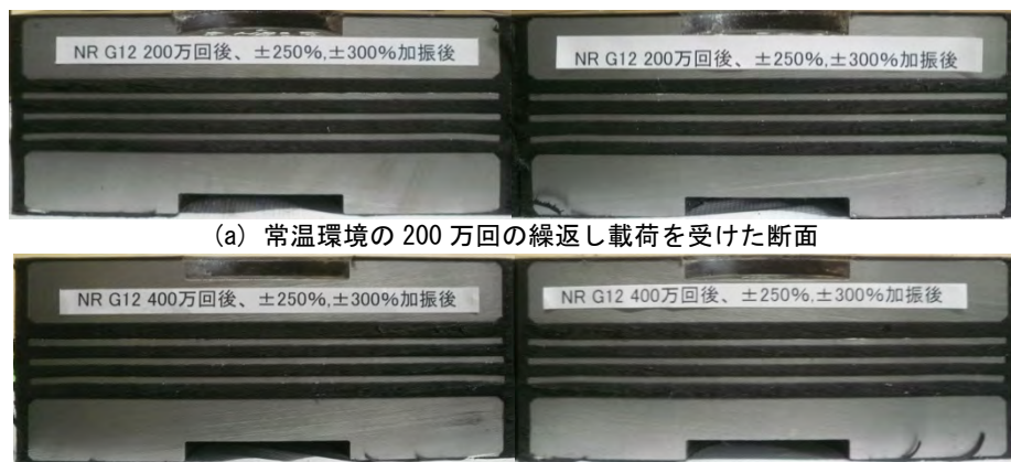
(b) 低温環境の 400 万回の繰返し载荷を受けた断面
