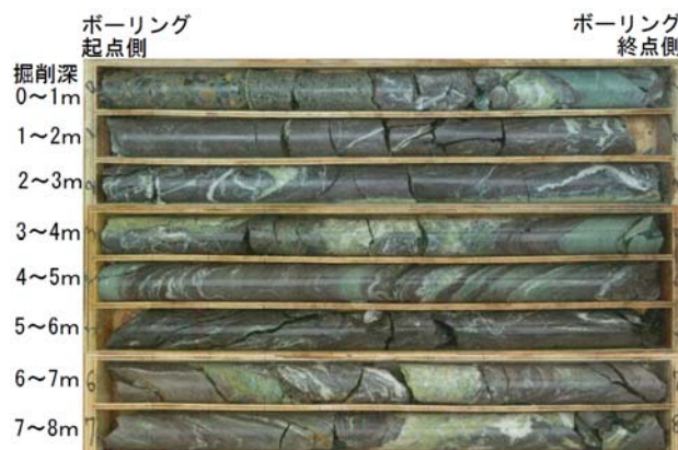
写真-1 ボーリングコア (走行車線側 TS-1)
