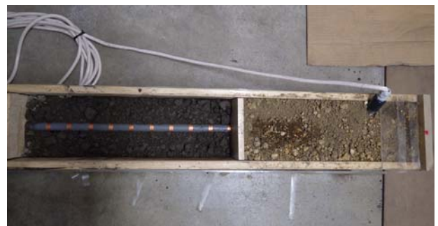
写真-2 試験試料および凍結融解深度計の埋設状況
