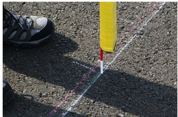
図-1 標尺と路面の接地状況
