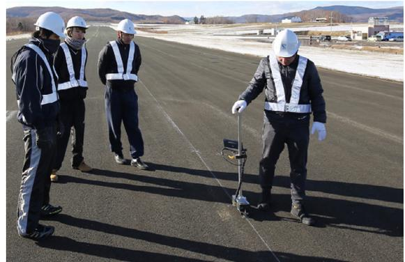
図-2 Dipstick による測定状況
