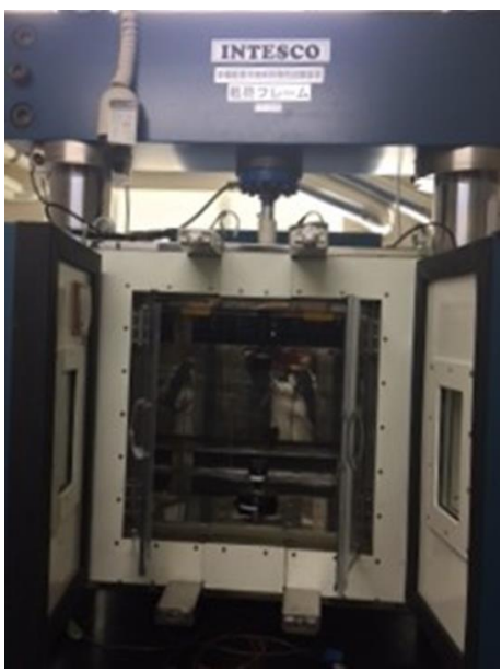
写真-1 多機能寒冷地材料物性試験装置
