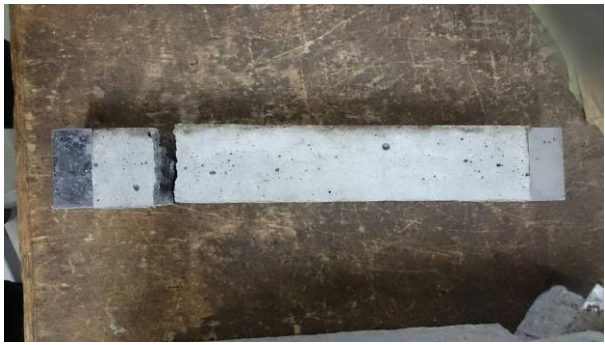
写真-3 角柱供試体の直接引張試験後
