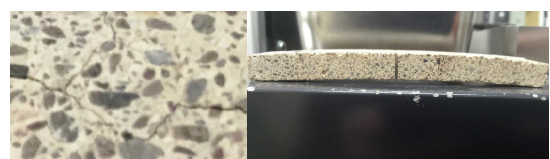
写真-3 気中養生におけるひび割れと変形
