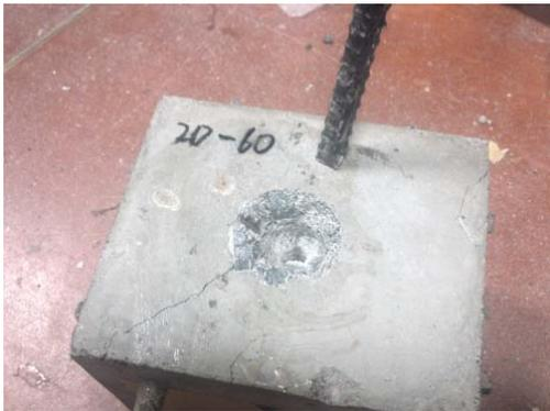
写真-1 引き抜け破壊した供試体の一例 (22-6)
