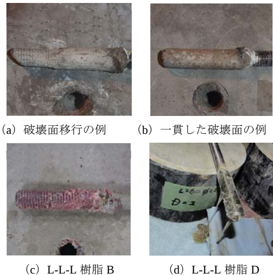
図-3 供試体の破壊面
