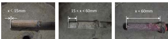
(a) 破壊 A (b) 破壊 B (c) 破壊 C
