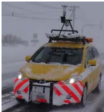
図1 移動気象観測車 (寒地土木研究所)
