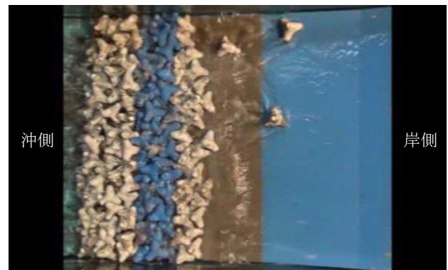
写真-3 ブロックの被災状況
