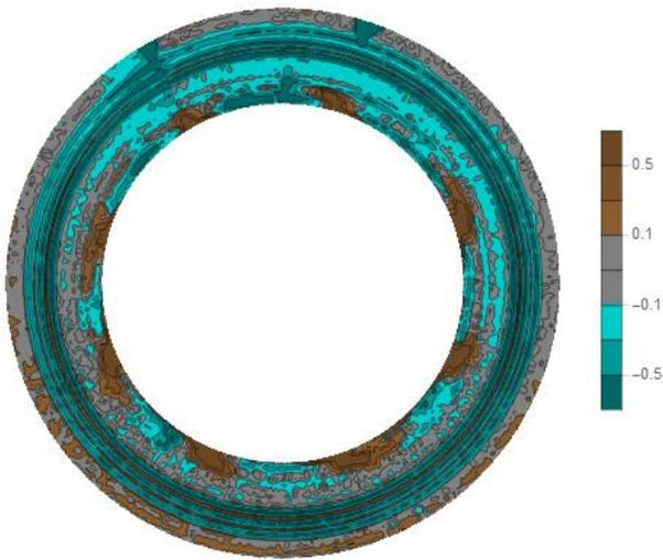
図-4 実験 1 10 時間後における岩盤の起伏
