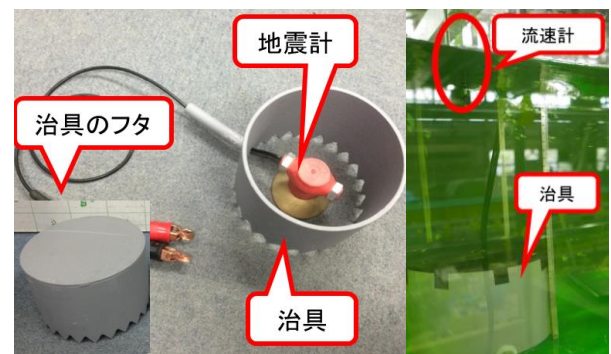
図-6 開発した治具と開水路実験の様子
