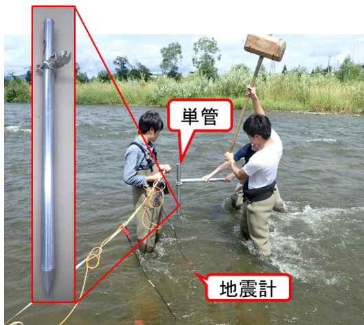
図-5 河道内での表面波探査の実施状況
