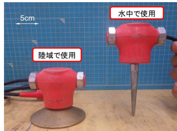
図-8 地震計の金属製土台部
