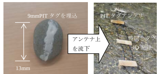
写真-2, 3 PIT タグ付き掃流砂、アンテナ敷設状況
