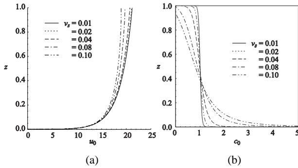
図-3 等流状態における(a)流速および(b)浮遊砂濃度分布.
