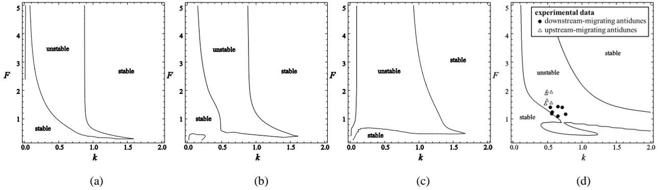
図-4 混濁流に発生する河床不安定現象のダイアグラム.
