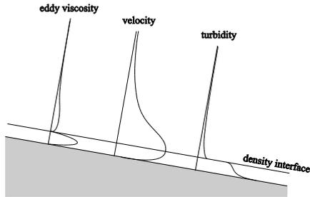
図-1 等流状態で流れる混濁流の概念図.
