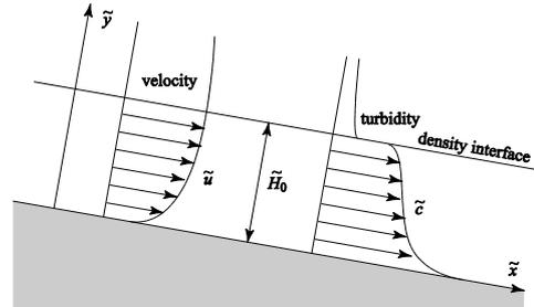
図-2 高濃度層内の流れの概念図と座標系.
