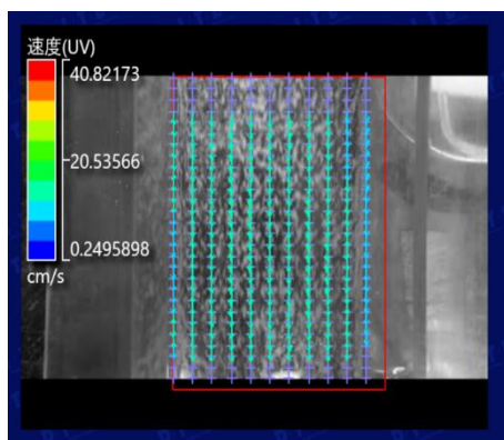
図2 粒子を用いた撮影をPIV解析している様子
