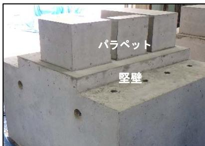
写真-2 衝突実験供試体
