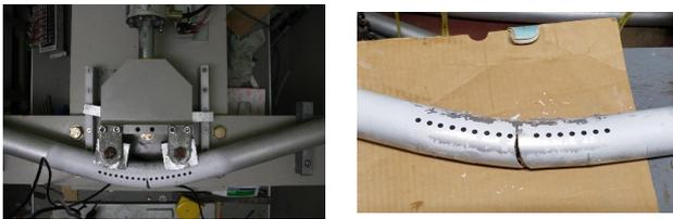
図-3 凍結砂充填単管パイプの破壊形式と破壊点
