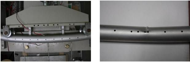
図-2 中空単管パイプの破壊形式と破壊点
