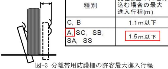
図-3 分離帯用防護柵の許容最大進入行程
