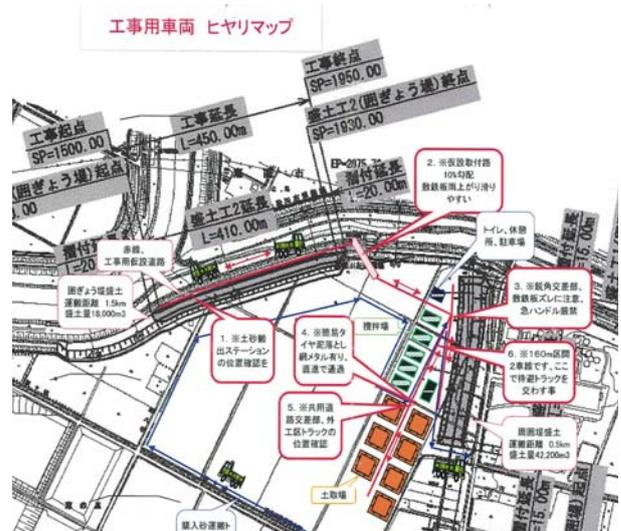
図-2 工事ダンプ走行路概要図（ヒヤリマップ）
