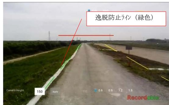
写真-3 逸脱防止ライン認識確認
