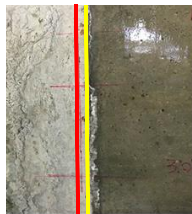
図-6 塩入コンクリート供試体の塩水流下後
