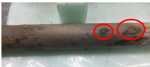
写真-7 腐食状況（ケース 3-1 塩分吸着剤 1.4kg/m<sup>2</sup>）
