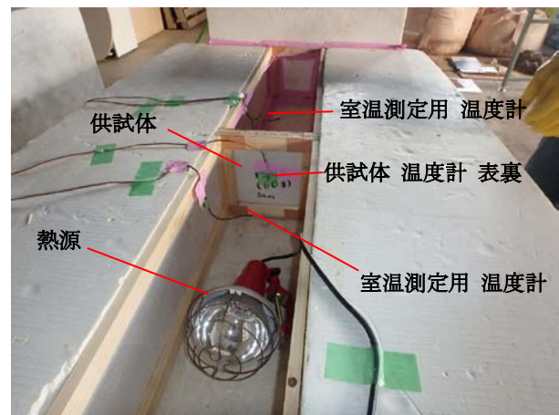
図-4 保温室内部
