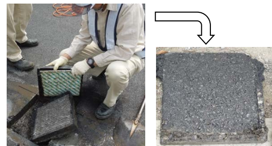
写真-4 採取状況と採取した供試体の例
