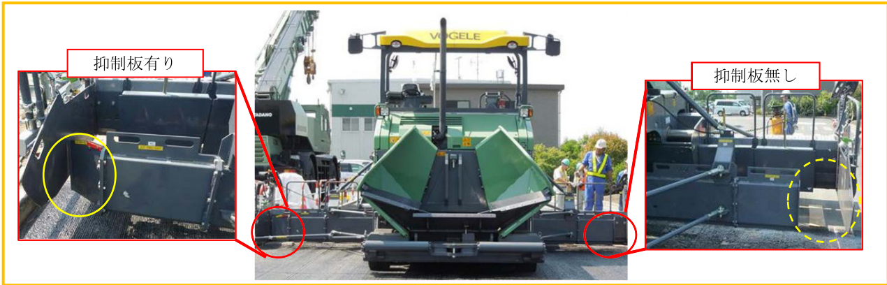
写真－1 アスファルトフィニッシャーの抑制版の装着状況（装着の有無）
