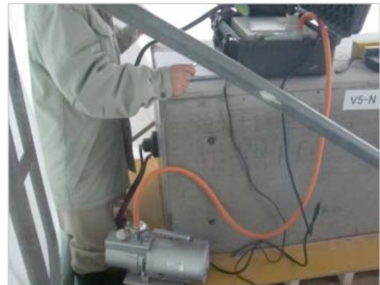
写真-3 表面透気試験実施状況
