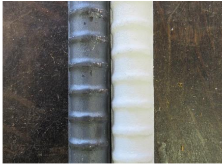
(左：無処理鉄筋 右：溶射鉄筋) 写真-1 鉄筋の外観
