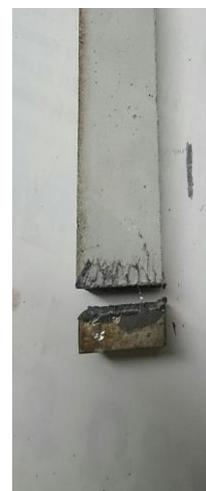
写真-2 引張試験を行ったモルタル供試体
