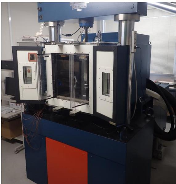
写真-1 多機能寒冷地疲労試験機
