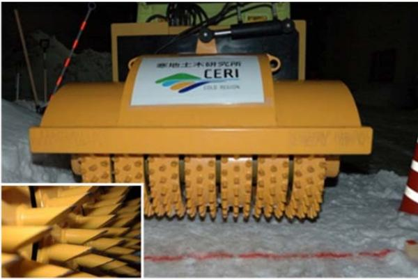
写真-2 雪氷路面処理装置の破碎部
