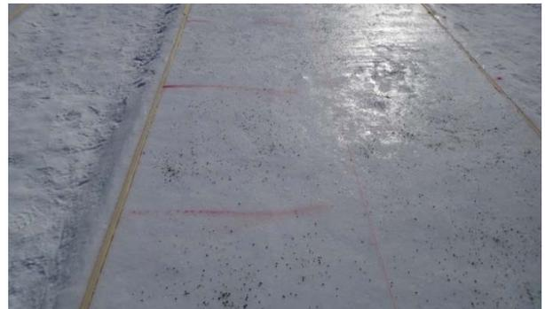
写真-5 構築したアイスバーン状況(碎石散布)
