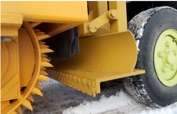
写真-3 雪氷路面処理装置の排雪部
