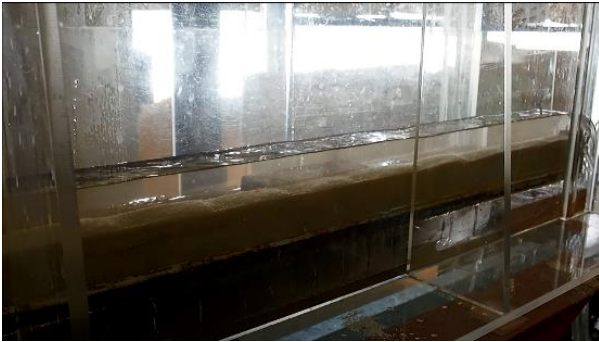
図 11 流量①で浚渫後再び河床形態を形成
