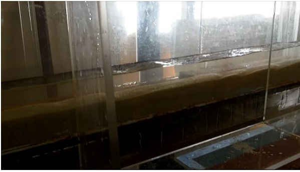
図 10 流量①で浚渫後、下流側の波形が消滅
