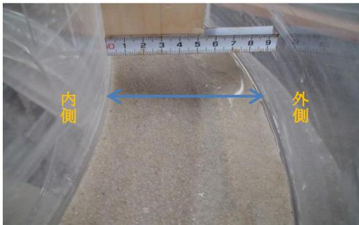
図-3 水路断面の測定位置 1cm(内側)-9cm(外側)
