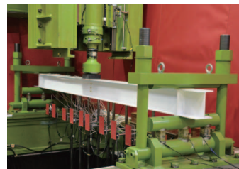
写真-1 試験体の設置状況 ( L=3\text{ m} の場合)
