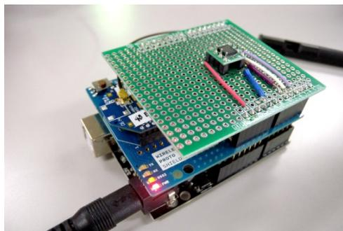
写真-2 構築した小型振動センサ検知部の外観
