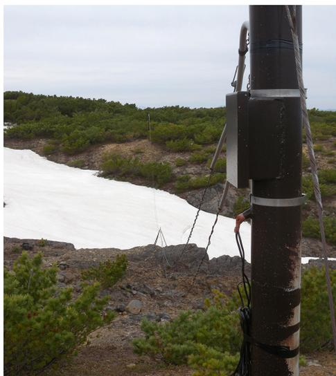
写真-1 積雪環境下で十勝岳に設置されているワイヤセンサ (2015/5/12 撮影)
