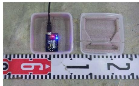
写真-3 耐寒保護を施した後の外装（上段が振動検知及び送信部、下段が受信部）
