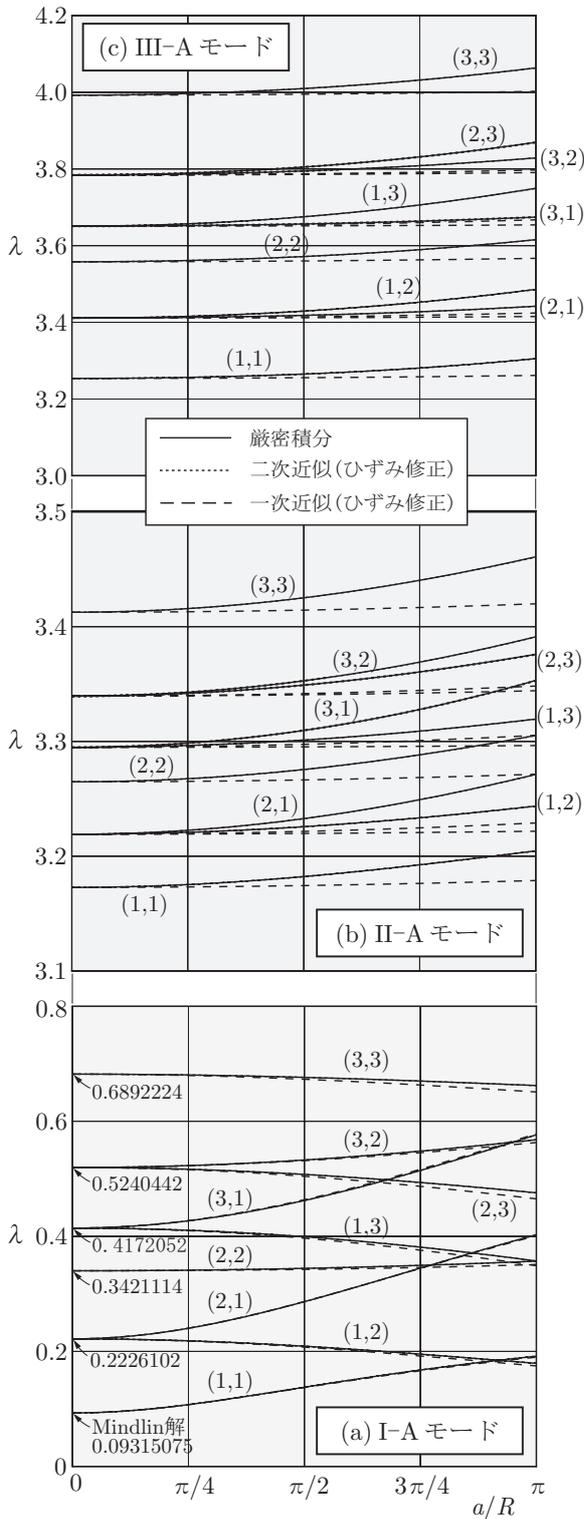
図-5 曲げ振動モードにおけるひずみ近似の影響
