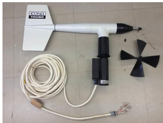
図-3 観測に使用した風速計
