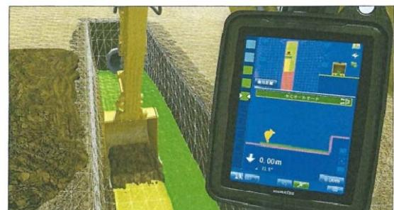
写真-1 バックホウ・マシンガイダンスのコンソール
