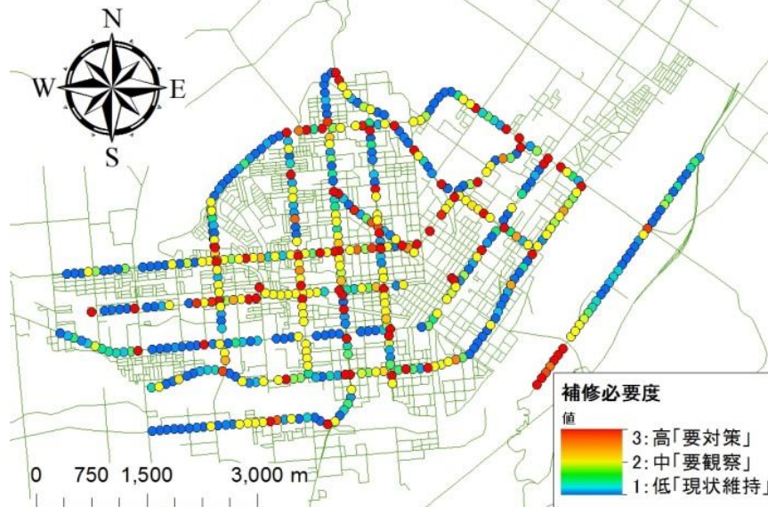
図-5 ファジィ理論を用いた補修必要度による路面モニタリング
