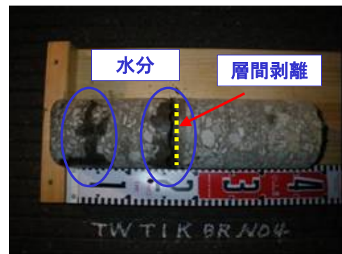
写真-2 ブリストリングが発生した採取した無水コア
