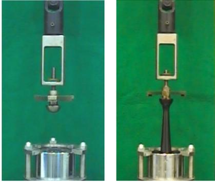
写真-1 タフネス・テナシティ試験の状況
