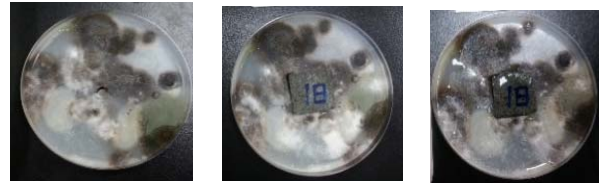
写真-2 焼成 HP1.0%のモルタル片の経過
