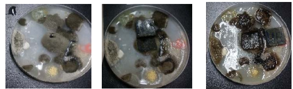
写真-3 焼成 HP0%のモルタル片の経過
