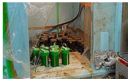
写真-1 蒸気養生の様子
