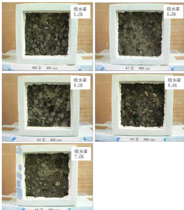
写真-3 スケーリング状況（300 サイクル時）
