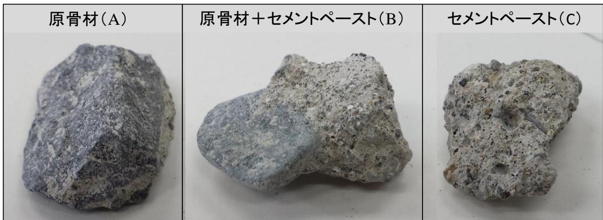
写真 1 再生骨材の種類
