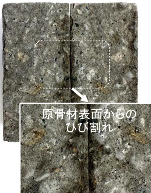
写真3 低品質再生骨材コンクリートの破断面
