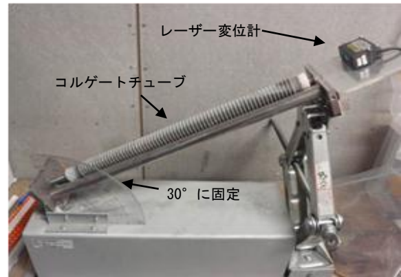
写真-1 長さ変化測定装置
