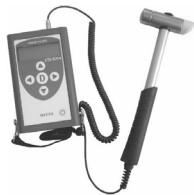
写真1 機械インピーダンスハンマー(380g)
