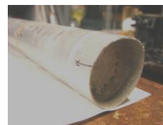
図-3 モルタル充填単管
