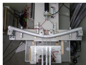
図-2 4点載荷実験装置
