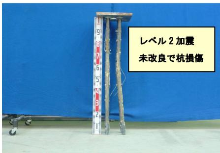
写真-2 レベル 2 加振の杭変形 (ケース 1)
