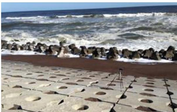
写真-2 最大遡上高さの計測状況
