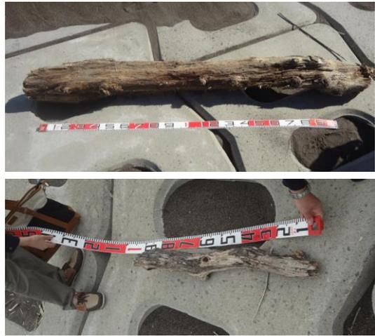
写真-3 流木長さの計測状況
