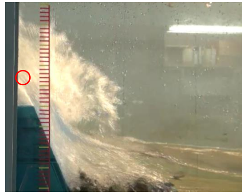
図-3 越波により打ち上げられた粗石の状況
