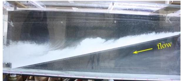
図-3 混濁流が水路内を流下する様子
