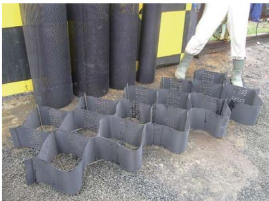
写真-1 実験に使用したジオセルの外観
