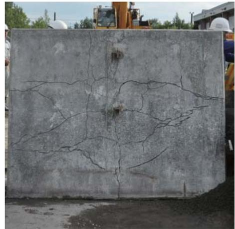
写真-3 擁壁の破壊性状 (N-1.0 試験体)
